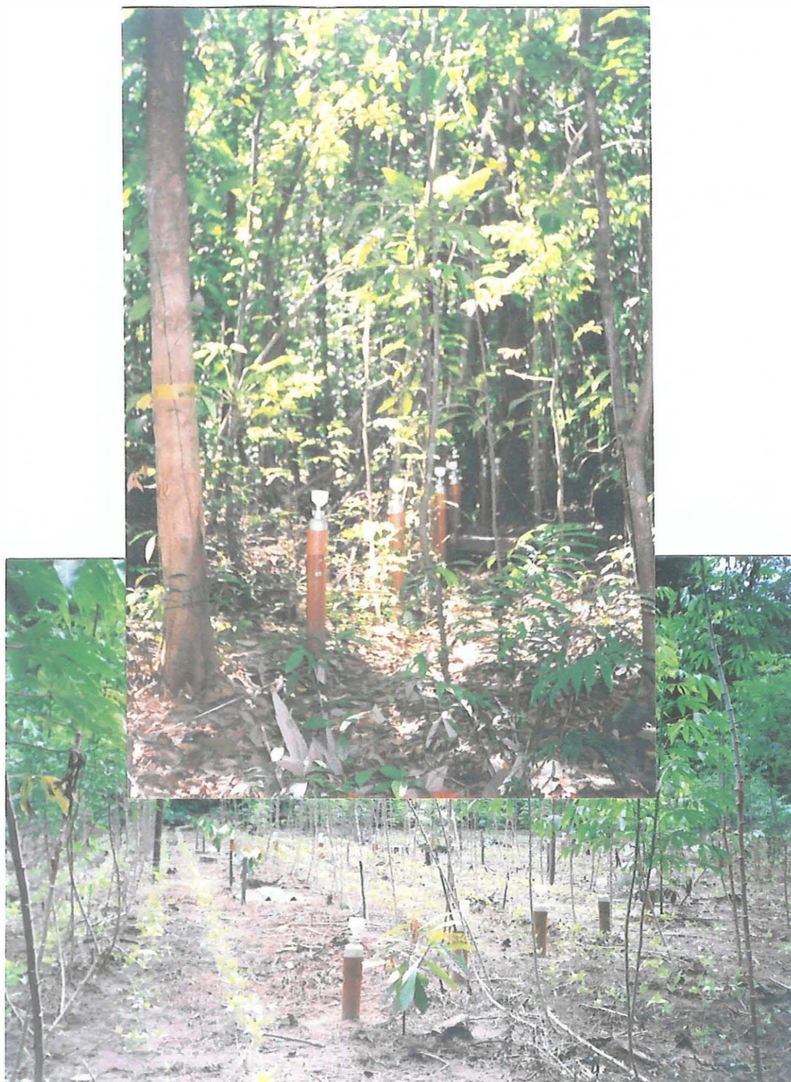
Figura 8 - Fotos da área mostrando a distribuição dos pluviômetros instalados na área de floresta e do SAF.
