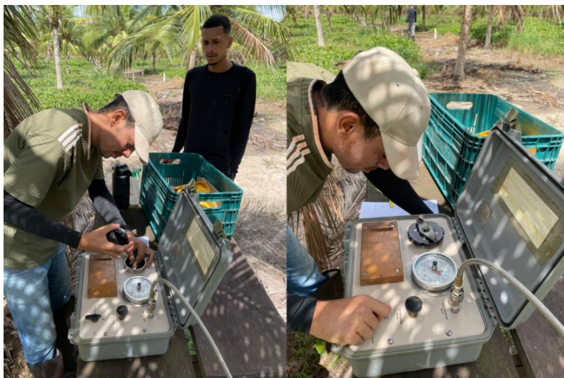
Figura 1.5 – Avaliação do potencial hídrico foliar com auxílio de uma bomba de pressão de Scholander
