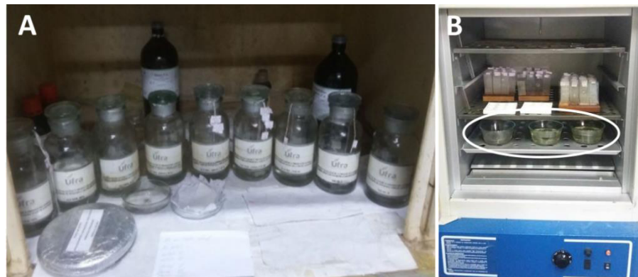
Figura 7: (a) Bateria alcoólica para desidratação do material em escala crescente. (b) Estufa contendo parafina líquida para impregnação em material, destacado pelo círculo.
