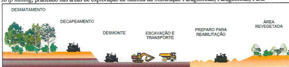
Figura 1 – Croqui evidenciando as etapas do processo de extração de bauxita pelo método a céu aberto do tipo strip mining , praticado nas áreas de exploração de bauxita da Mineração Paragominas, Paragominas, Pará.
