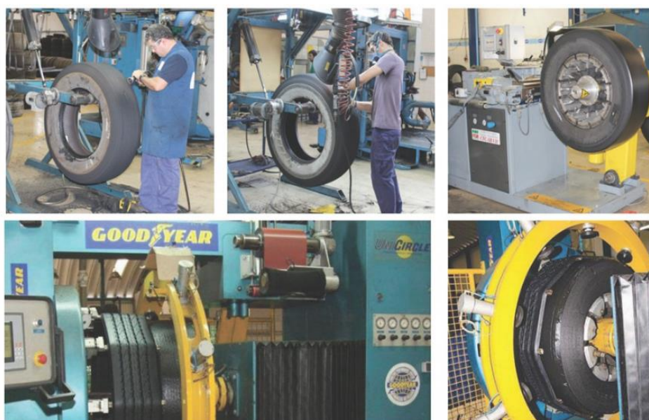
Figura 2.9 – Preparação, reparação e aplicação do piso.
