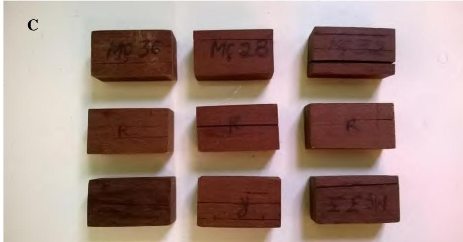
As rachaduras nos corpos-de-prova foram ocasionadas pela aplicação do processo de termorretificação, em particular nas espécies maçaranduba e pau-roxo.
