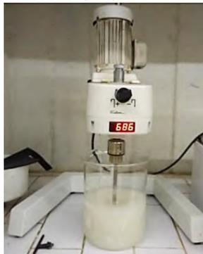
A obtenção das nanofibrilas de celulose (NC) foi por meio de desfibrilação mecânica utilizando um Super Mass Colloider Grinder (Masuko Sangyo MKCA6-2) com rotação do disco inferior de 1500 RPM com 3 e 21 passagens (3P e 21P, respectivamente) pelo equipamento (Figura 7).
