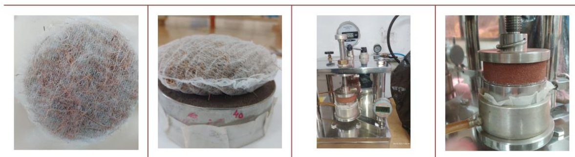
Figura 1 – Sacos flexíveis com EFB, na superfície dos anéis, e durante o ensaio de compressão uniaxial
