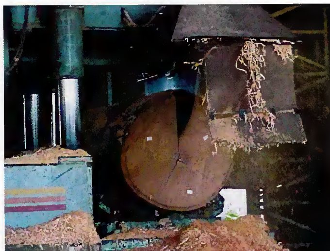
Figura 31. Marcação e corte para obtenção dos blocos em serra
