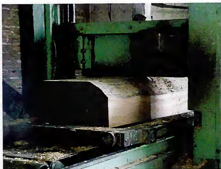
Figura 35. Filé pronto com face plana para faqueamento.
