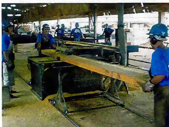
Figura 06. Corte 2 de serrado proveniente do Corte 1, em multi-serra.
