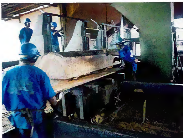
Figura 03. Serra de fita – desdobro primário.
