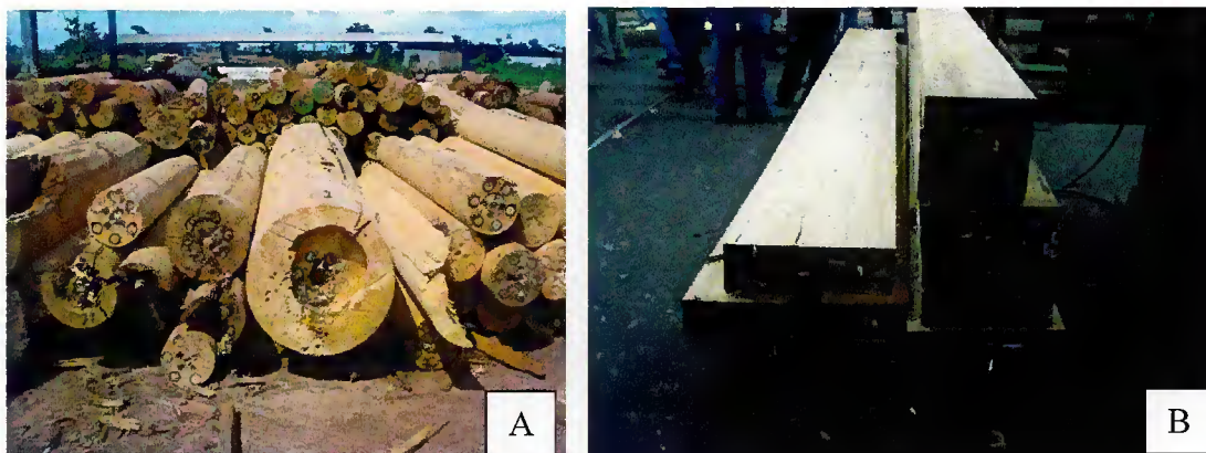
Figura 65. Resíduos causados pela falta de Qualidade e Sanidade das toras, resíduos de torno (A) e resíduos de faqueadeira (B)
