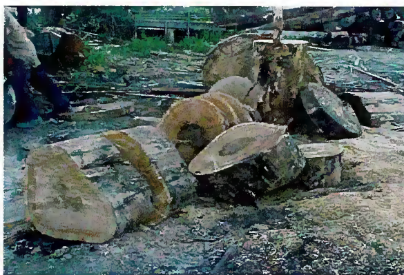
Figura 24. Sobras de fuste após a retirada de defeitos (podridão do topo).
