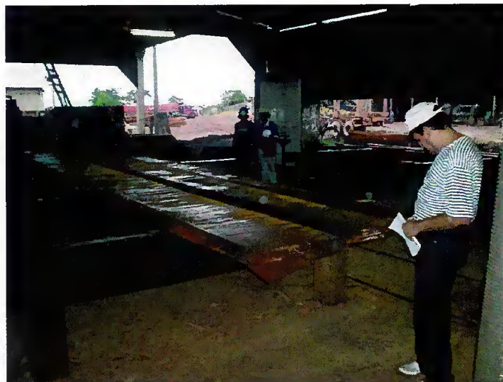
Figura 05. Medições de espessura, largura e comprimento da peça produzida no Corte 1.
