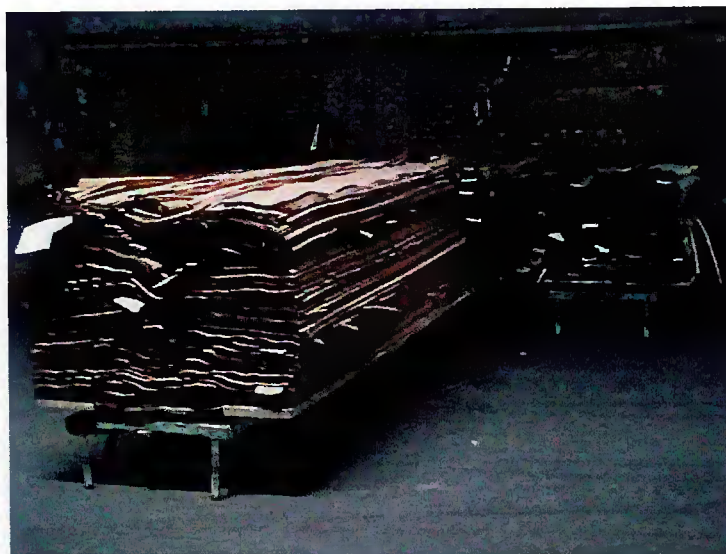
Figura 38. Feixes de lâminas de madeira após a secagem
