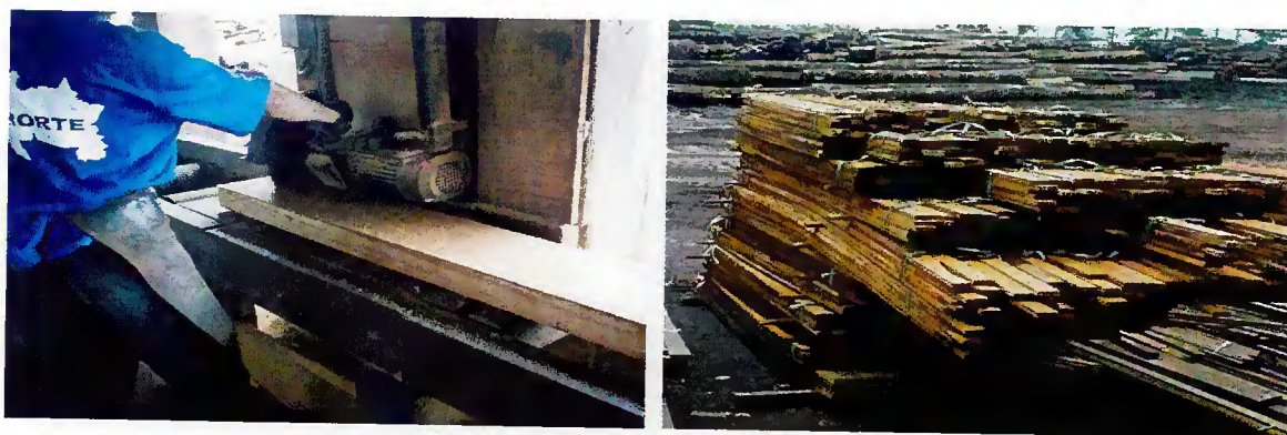
Figura 13. Corte em destopadeira para padronização do comprimento da peça. Figura 14. Lotes de serrados de diferentes comprimentos.
