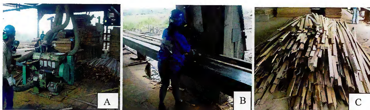
Figura 22. Ripeira (A) para produção de ripas e Destopadeira (B) para padronização de comprimento de ripas e Lote de ripas (C)
