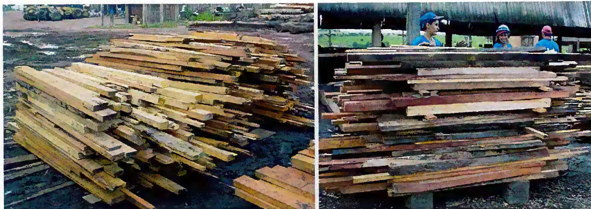
Figura 17: Peças de madeira destopadas para serem processadas no setor complementar de reaproveitamento de resíduos para ripas e sarrafos.
