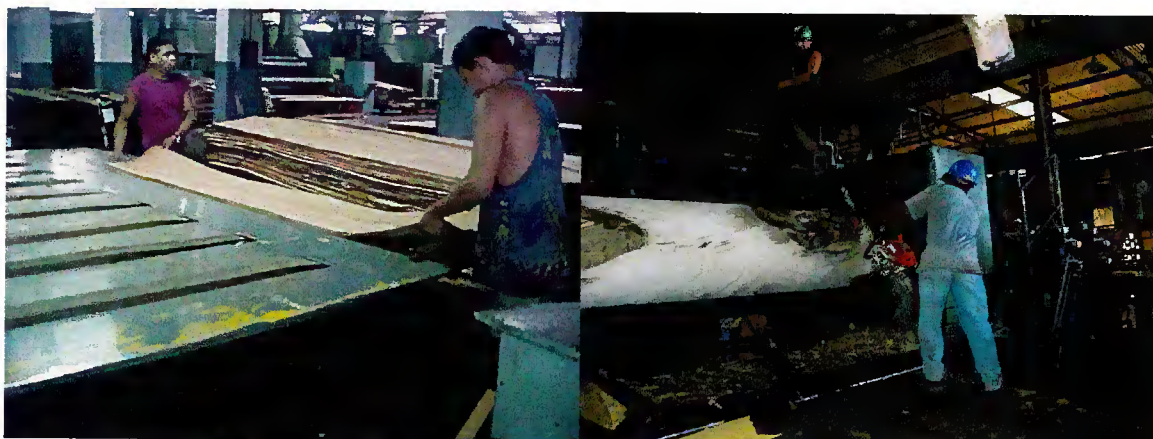
Figura 70. Funcionários sem nenhum treinamento, subindo no equipamento, usando equipamento indevido para essa operação, sem uniforme adequado e sem usos de EPIs.
