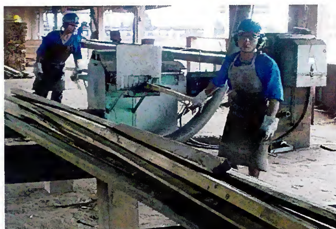
Figura 10. Reaproveitamento de resíduos oriundos do Corte 4, em serra circular para produção de ripas.
