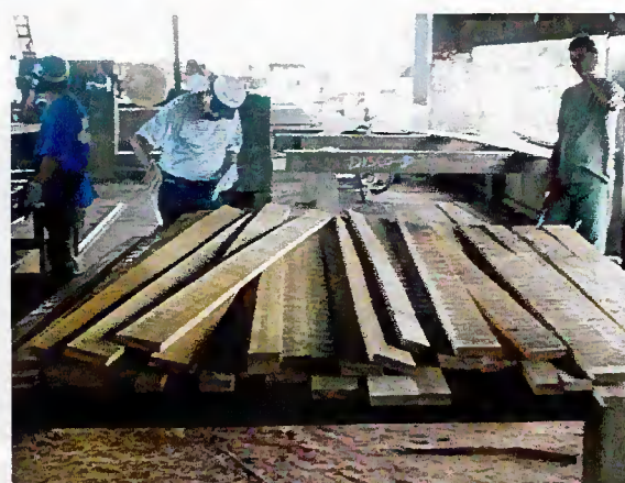
Figura 07. Serrados obtidos no Corte 2, em multi-serra.
