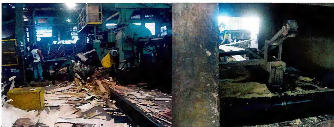
Figura 68. Maquinários em precárias condições de funcionamento e sem nenhuma regulagem e manutenção
