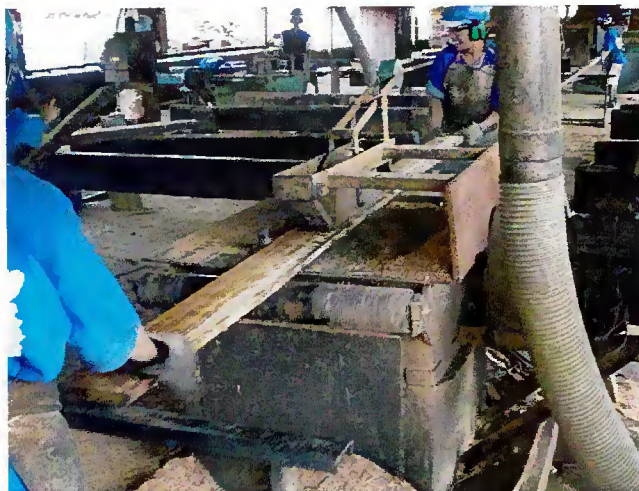
Figura 09. Reaproveitamento de resíduos oriundos do Corte 2, em serra circular.
