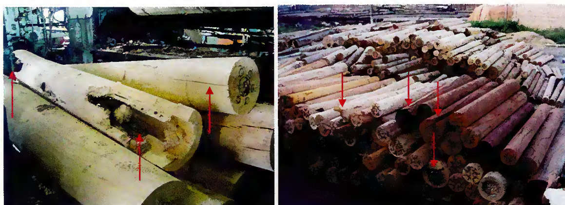
Figura – 55. Pilhas de roletes mostrando a perda devido à sanidade da tora (podridão e rachaduras).
