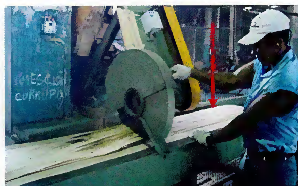
Figura – 28. Aproveitamento de lâminas impróprias oriundas da guilhotina grande para produção de lâminas transversais para compensado.
