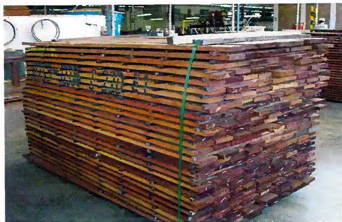
Figura - 56. Amostra de um lote de serrado bruto seco sem ataque de agentes biodegradadores.
