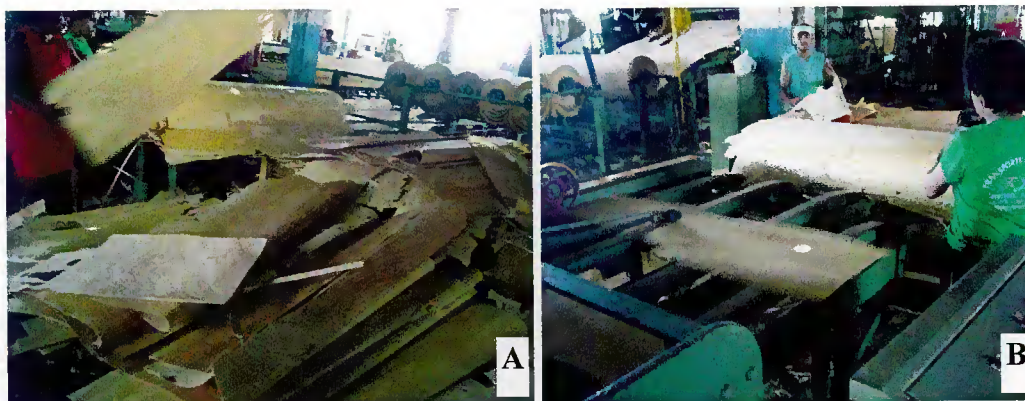
Figura – 29. (A) Lâminas impróprias oriundas de cilindramento da tora e (B) Corte na guilhotina pequena para produção de lâminas transversais para compensado.
