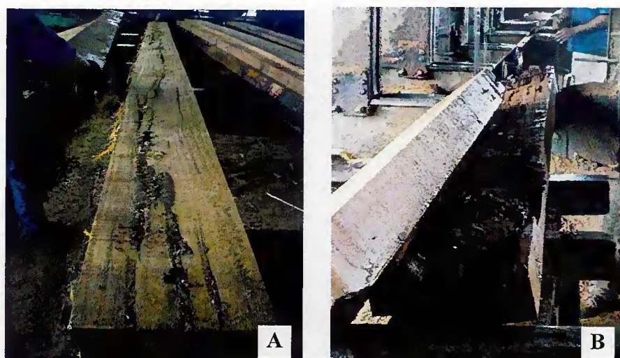
Figura 53. Peças de madeira com podridão interna causando redução no aproveitamento.
