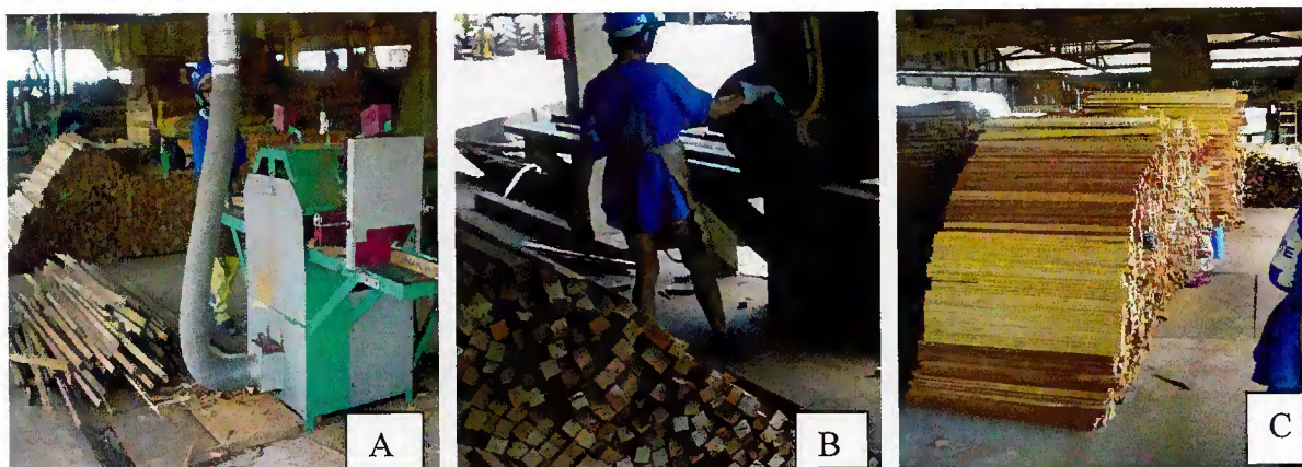
Figura 23. Esquadrejadeira (A) para produção de sarrafos, Destopadeira (B) para padronização de comprimento de sarrafos e Lote de sarrafos (C).
