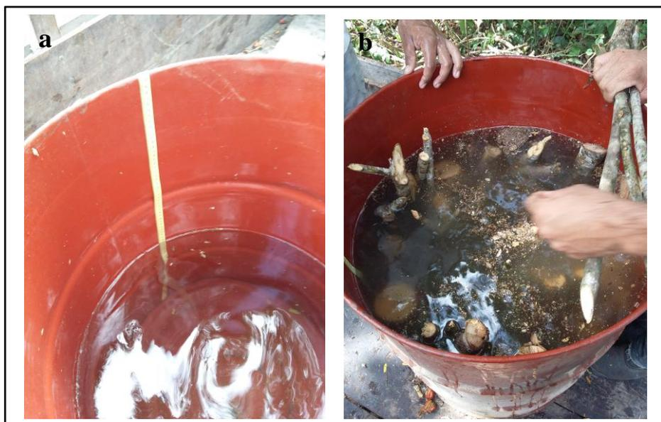
**Figura 2-** Mensuração do volume da madeira de poda do componente arbóreo pelo método do xilômetro.
